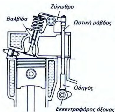
Σχ. 6/13: Καταπόνηση διωστήρα μηχανής εσωτερικής καύσης σε λυγισμό.
