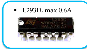
Σχήμα 4.3: Οι οδηγοί ισχύος τύπου γέφυρας .
