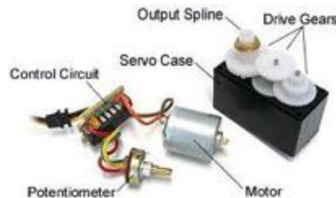
Εικόνα 4.1.3 Εσωτερικό ενός κινητήρα τύπου «RC SERVO»
